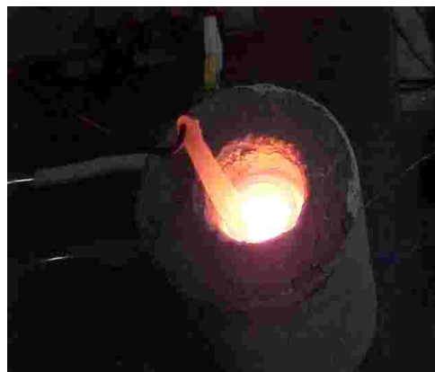
Fig. 2.- Fundición de vidrio por inducción electromagnética [Ref 13]
