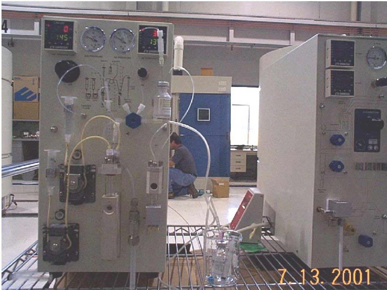
Figura 3. Modulo de síntesis del [ ^{11}\text{C} ]-acetato.
