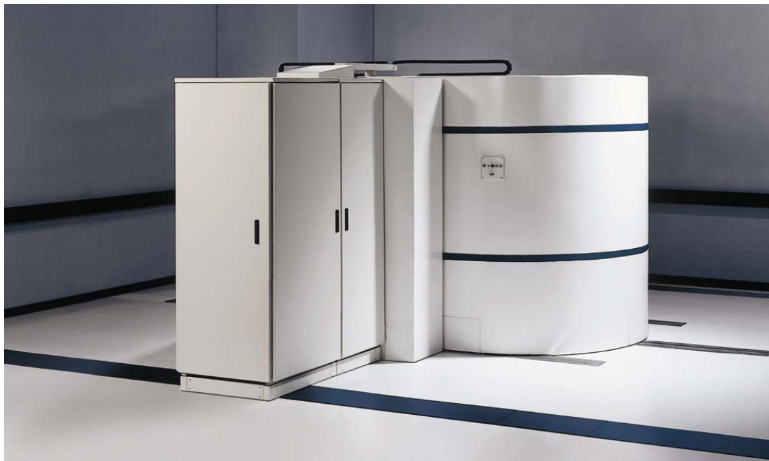
Figura 6. Vista panorámica del acelerador de partículas tipo ciclotrón (RDS 111 de 11 MeV).
